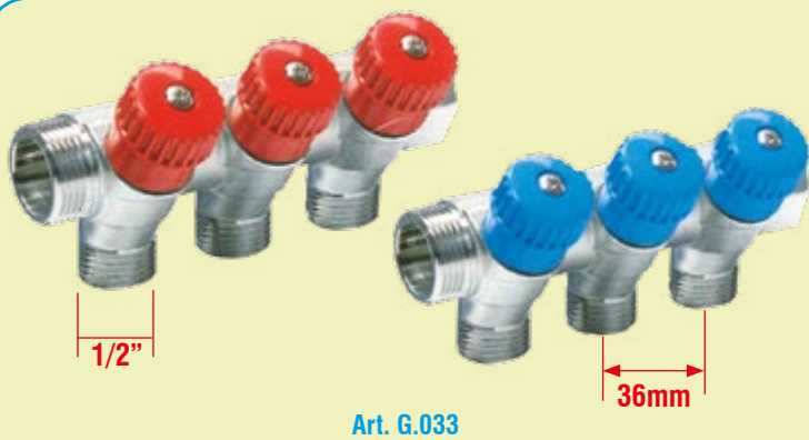
Art. G.033 - Collettore in ottone modulare componibile da 3/4" M.F. con rubinetto di intercettazione integrato nelle varie derivazioni da 1/2" M. Interasse delle derivazioni 36 mm.
