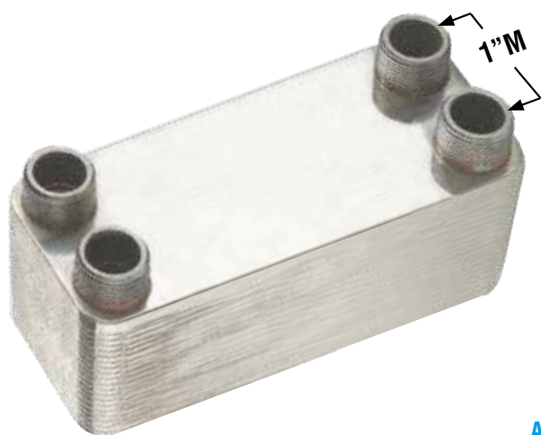
Art. S.009 – Scambiatore tipo XS 286 x 112 a piastre saldobrasate, con attacchi filettati 1" M. x 1" M.
