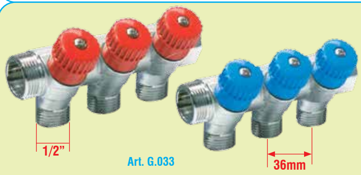
Art. G.033 – Colector modular componibil din alamă, de 3/4" M.F., cu robinet de închidere integrat pe fiecare derivație de 1/2" M. Interaxă: 36 mm.
