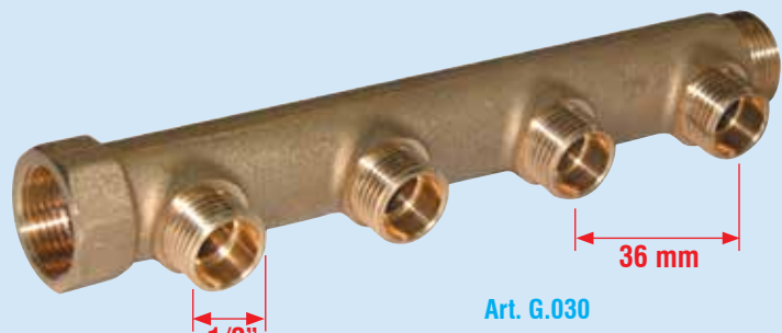
Art. G.030 – Colector modular componibil din alamă, cu derivații de 1/2" M. Interaxă: 36 mm.
