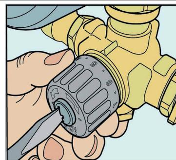
Attention: en phase de réglage, attendre que le thermomètre de lecture soit stabilisé avant d'effectuer une nouvelle manoeuvre.
