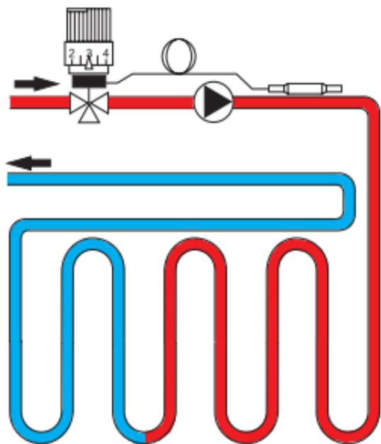
**Regolazione della temperatura dell'acqua nel serpentino negli impianti a pavimento**
