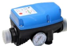
**Presso-flussostat électronique** pour la régulation automatique de la pression dans les installations hydrauliques asservies par électropompes et pour la protection contre le manque d'eau. Avec manomètre. Raccords: 1" M. x 1" M. Alimentation: 220/240 V. - Protection IP65.
