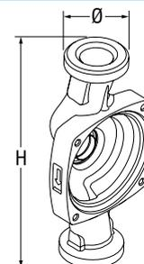
Art. P.153 - Corps de rechange en fonte pour circulateur avec sens de rotation anti-horaire (CCW). Avec 2 joints pour les raccords.
